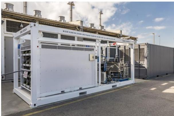
*Dresden/USA, 29. Februar 2016. sunfire hat die weltweit größte kommerzielle reversible Elektrolyse entwickelt und an Boeing ausgeliefert. Das Energiesystem sorgt für die verlässliche Bereitstellung von Strom auf Basis von Windkraft oder Photovoltaik mit Wasserstoff als Speichermedium. Es wird nun an einem Microgrid-Teststandort der US Navy in Kalifornien eingesetzt. Die Lösung, die die effiziente Langzeitspeicherung großer*
