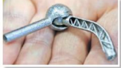
Auch aus dem 3D-Druck: Dieses Bauteil wäre mit herkömmlichen Verfahren gar nicht herstellbar. Foto: Dietrich Fraehner
