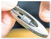
In einem Arbeitsgang im 3D-Druck gefertigt: Phantasiemodell mit beweglichen Teilen, das die Möglichkeiten demonstriert. Foto: André Weisig
