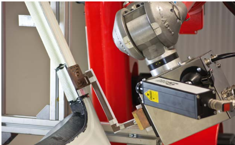
Pyrometergeregelte induktiv beschleunigte Klebstoffhärtung mit Industrieroboter © Fraunhofer IWS Dresden
