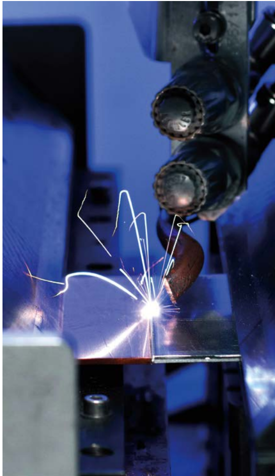
Prozess des Laserstrahlschweißens von Al-Cu-Verbindungen © Jürgen Jeibmann / Fraunhofer IWS Dresden
