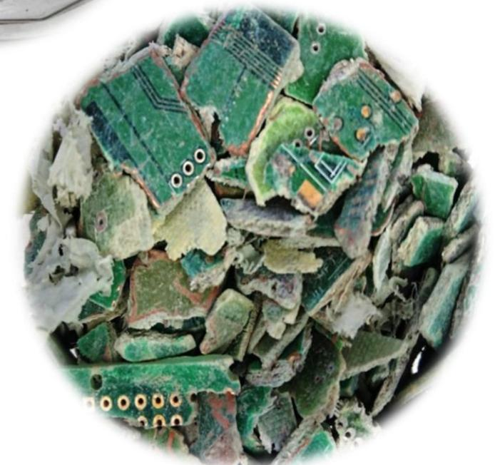
Die UHTH<sup>®</sup> Anlagen können grundsätzlich Materialien mit einem Feuchtigkeitsgehalt von ca. 10-30% und in einer Stückgröße von ca. 1.5 cm<sup>3</sup> bei der T5 und ca. 2,5 cm<sup>3</sup> der ähnlicher bei der T25 Dimension verarbeiten.
