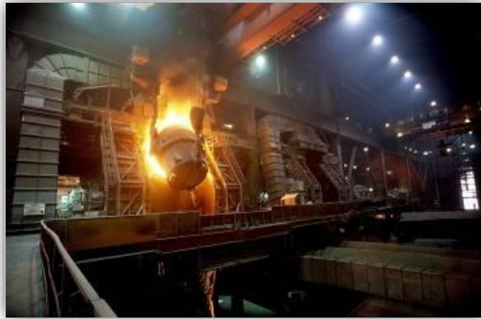
Konverterstahlwerk: Einstellung Stahlzusammensetzung
